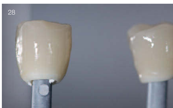
Abb. 28 Die Zirkonoxid-Ge- rüste und Lithiumdisil- ikat-Restaurationen sind nach dem Füge- brand homogen mit- einander verbunden
