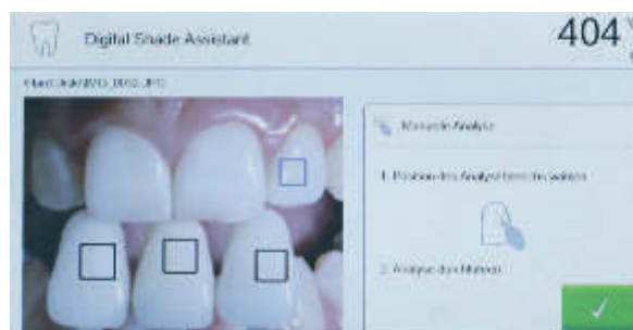
Abb. 7: Zusätzlich können über das Touchscreen manuell einzelne zu analysierende Bereiche (z. B. inzisal) angesteuert werden.
