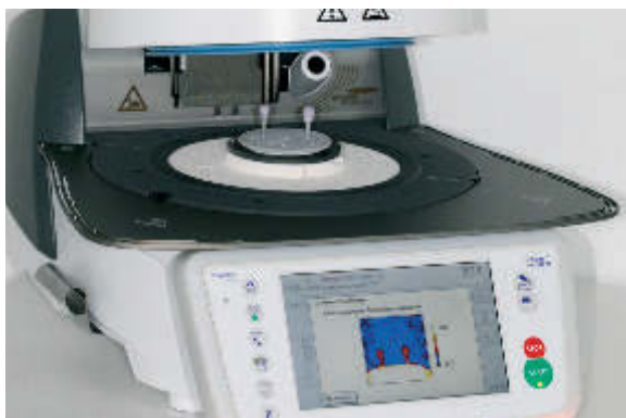
Abb. 11: Über die Infrarot-Technologie wird die Temperatur auf der Oberfläche des Brenngutes gemessen. Die Ofensoftware steuert automatisch den Vortrocknungs- und Schließprozess.
