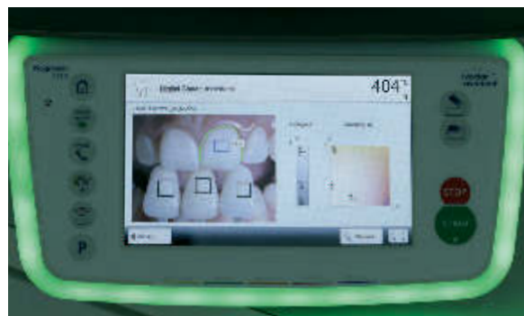
Abb. 5 u. 6: Der integrierte Digital Shade Assistant leistet hilfreiche Dienste bei der Farbkommunikation. Mit dem DSA-Holder werden im Mund Referenz-Zahnstäbchen fotografiert und die Informationen an den Ofen übertragen (USB-Stick). Hier wird automatisch die Grundzahnfarbe im zentralen Bereich des Zahnes ermittelt. Hinweis: Das Vorgehen ergänzt die herkömmliche Farbbestimmung optimal.
